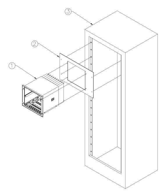
Монтаж мини-стойки 3500 и панели адаптера на рейках 19-дюймовой стойки EIA
