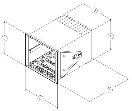
Установочные размеры мини-стойки 3500 для монтажа на панели
